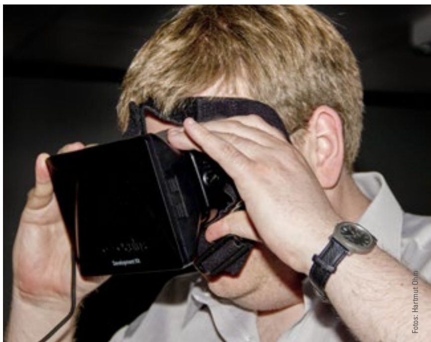
Die Oculus-Brille wird über einstellbare Gummigurte am Kopf gehalten. Zwei Mini-Monitore geben die Bilder wieder. Über Aufsätze können Brillenträgerinnen und -träger die Schärfe anpassen.
